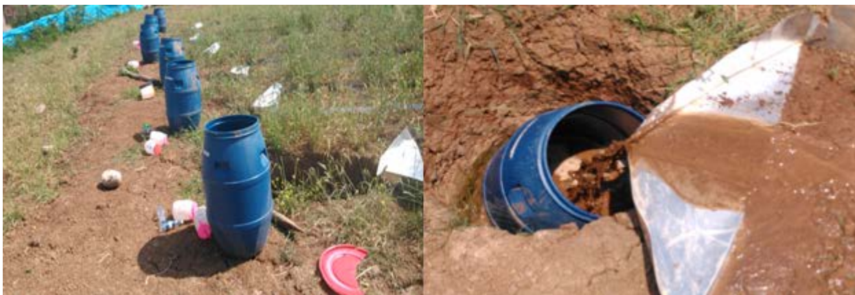
شکل ۴- برداشت نمونه‌های آب جمع‌آوری شده در مخازن انتهای کرت‌های آزمایشی و انتقال آن‌ها به آزمایشگاه
