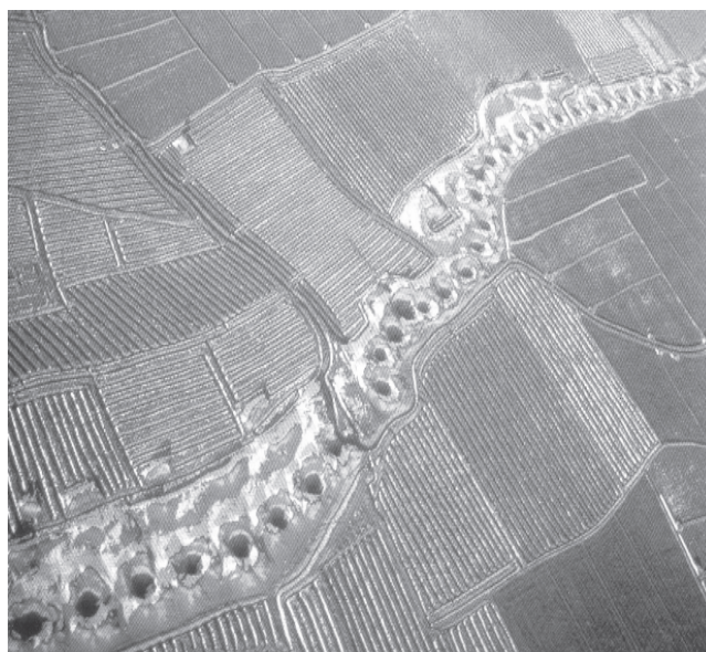
شکل ۲-چاه های قنات در اطراف زمین های کشاورزی به منظور استحصال آب
