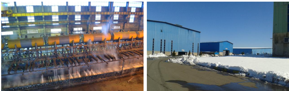
شکل 1: سوله‌های مجتمع فولاد گیلان (راست) و فرایند خنک کاری ورق گرم با آب (چپ)
