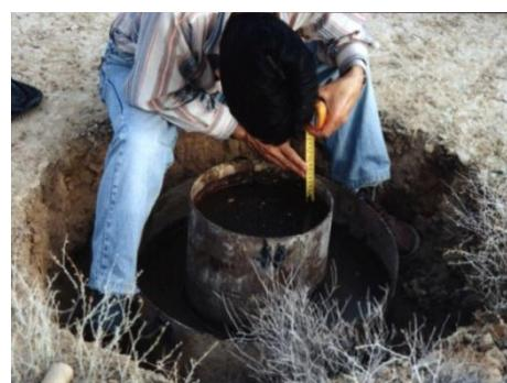
شکل ۴- اندازه‌گیری نفوذپذیری خاک در عمق  $0/5$  متری
