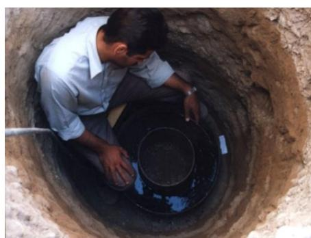
شکل ۵- اندازه‌گیری نفوذپذیری خاک در عمق  $2/5$  متری
